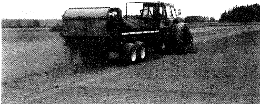
Bild 2. Fastgödselspridare med mottrycksreglerad matning för spridning av ensilage.
