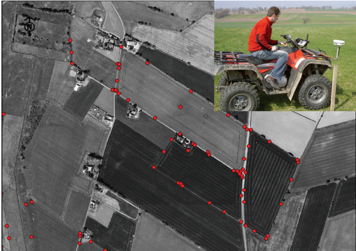
Figur 10. Inmätning av fält och försöksplats för Lindströmsprutan gjordes med nätverks-RTK GPS monterad på en fyrhjulig motorcykel (övre högra hörnet). Den stora bilden visar mätpunkter lagda ovanpå ett ortofoto för att underlätta skapande av fältpolygoner.
