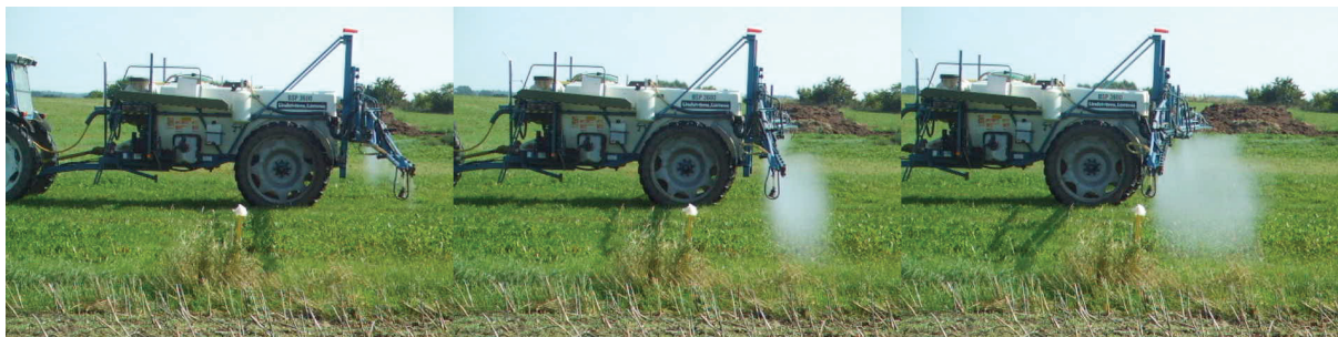
Figur 7. Videofilmerna analyserades bild för bild när sprutan passerade gränsen, här markerad med en plastkäpp med vit flagga. Bilden till vänster visar när rampen aktiveras, bilden i mitten när sprutduschen är fullt utvecklad och nått marken, och bilden till höger visar när rampen passerar gränsen. Tidskillnaden mellan mittbilden och högerbilden gav, tillsammans med hastigheten, avståndet mellan önskad och verklig gräns.
