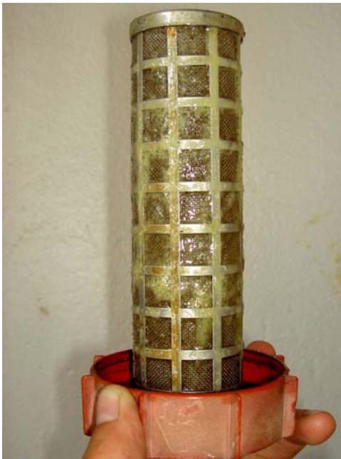
Figur 3. Då gräddning uppstod i tanken fastnade olja i sprutans sug- och munstycksfilter.
