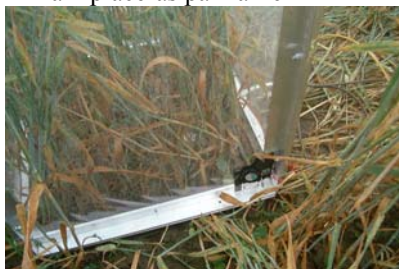
En fläkt ventilerar kyvetten
