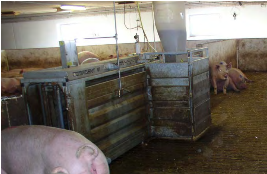
Figur 2. ESF-system till dräktiga suggor. Foderstation av Typ B.
