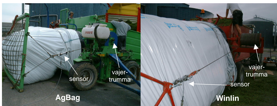
Figur 5. Position av vajerspänningssensorer på AgBag- och Winlin-packarna.
