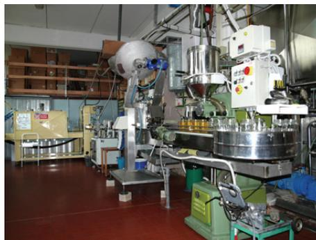
**Figura 1.9** – Invasettamento con impianto dosatore
