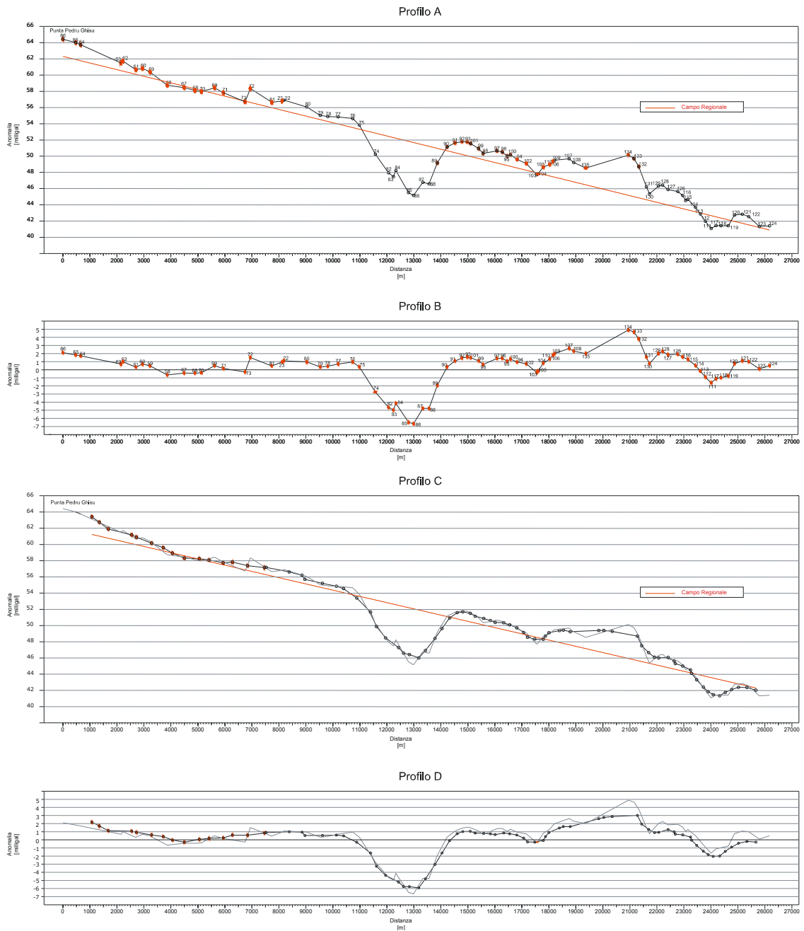
Figura 4.3 - Profilo gravimetrico A-A'
