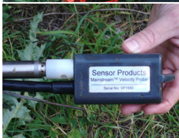
Figura 8.12 - (a) Microprocessore-datalogger del misuratore di portata Area-Velocity Mainstream; (b) sensore combinato di misura del livello idrico e della velocità media della corrente
