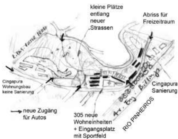
Skizze des Sanierungsprojekts (Zeichnung der Verfasserin)
