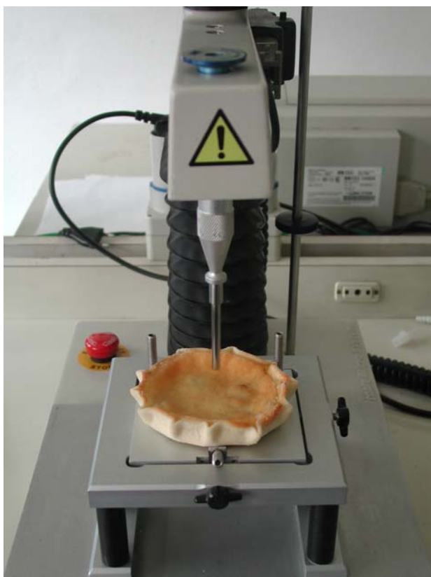
Fig. 21 – Test di compressione.
