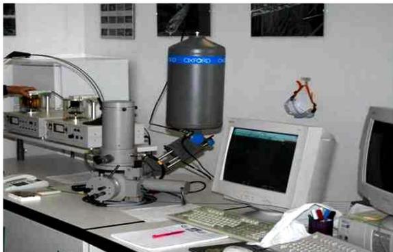
Figura 3: Microscopio elettronico a scansione con rivelatore EDS
