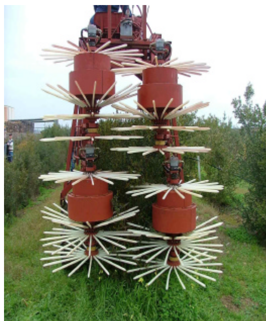
Figura 3. Gli organi di lavoro sono rappresentati da una serie di aste battitrici montate su due rotori per parte.
