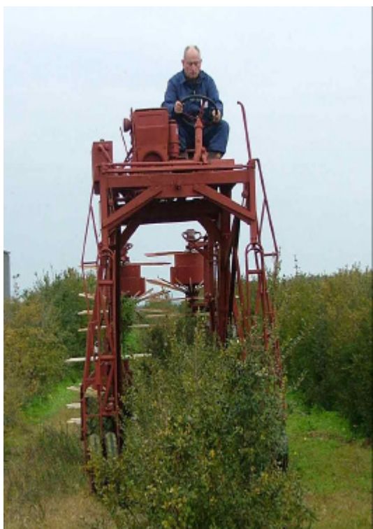
Figura 2. La scavallatrice è costituita da un telaio su cui sono montati il motore, gli organi di lavoro e di servizio.
