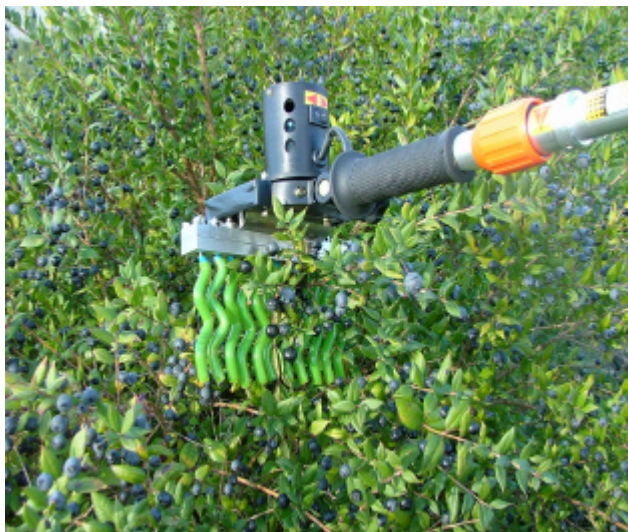
Figura 1. La macchina è dotata di un motore elettrico e di un pettine formato da una serie di onduline controrotanti. Inoltre, può essere dotata di un’asta telescopica per raggiungere le parti più alte della chioma della pianta.
