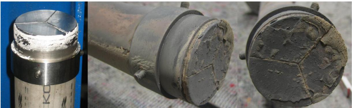
Abbildung 5-4: LPR-Korrosionssonde vor und nach dem Einsatz im Block F
