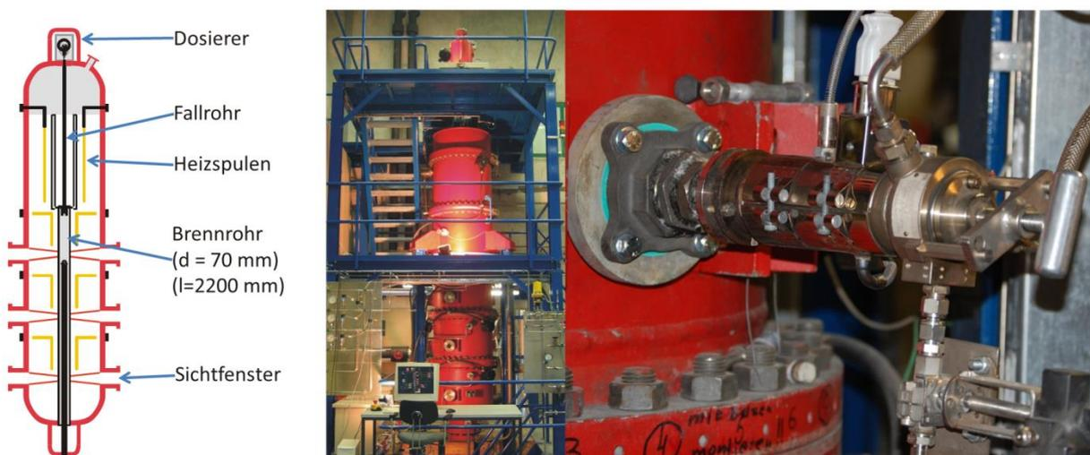
Abbildung 6-1: Flugstromreaktor des EST mit angeflanschter Gasentnahmesonde (rechts)
