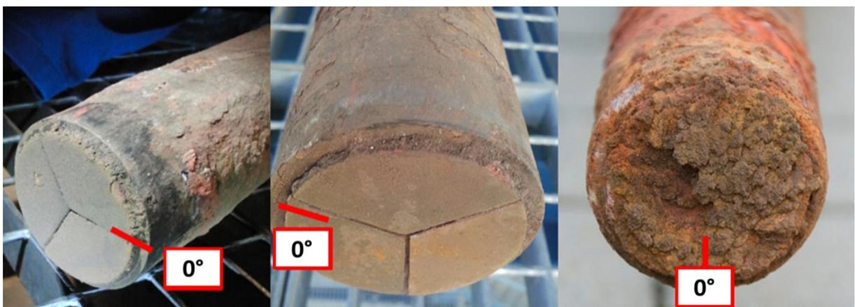
Abbildung 5-31: Vergleichsbilder der Sonde mit 13CrMo44 als Sensorelement zu verschiedenen Zeitpunkten; links: Dezember 2011, Mitte: April 2012, rechts: Juni 2012
