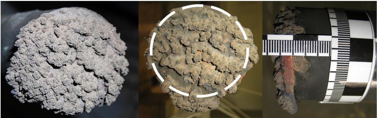
Abbildung 5-15: Sonde nach dem Ausbau aus dem Dampferzeuger F2
