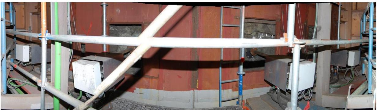
Abbildung 5-22: Panoramabild der vier LPR-Korrosionssonden, eingebaut im Dampferzeuger D1 des Kraftwerks Jänschwalde (Bild: Februar 2011)
