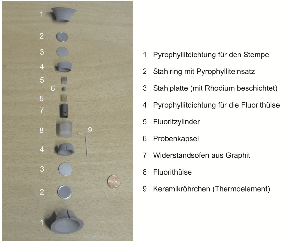
Abb. 3.7: Komponenten der in einem Belt-Apparatur-Experiment verwendeten Druckzelle
