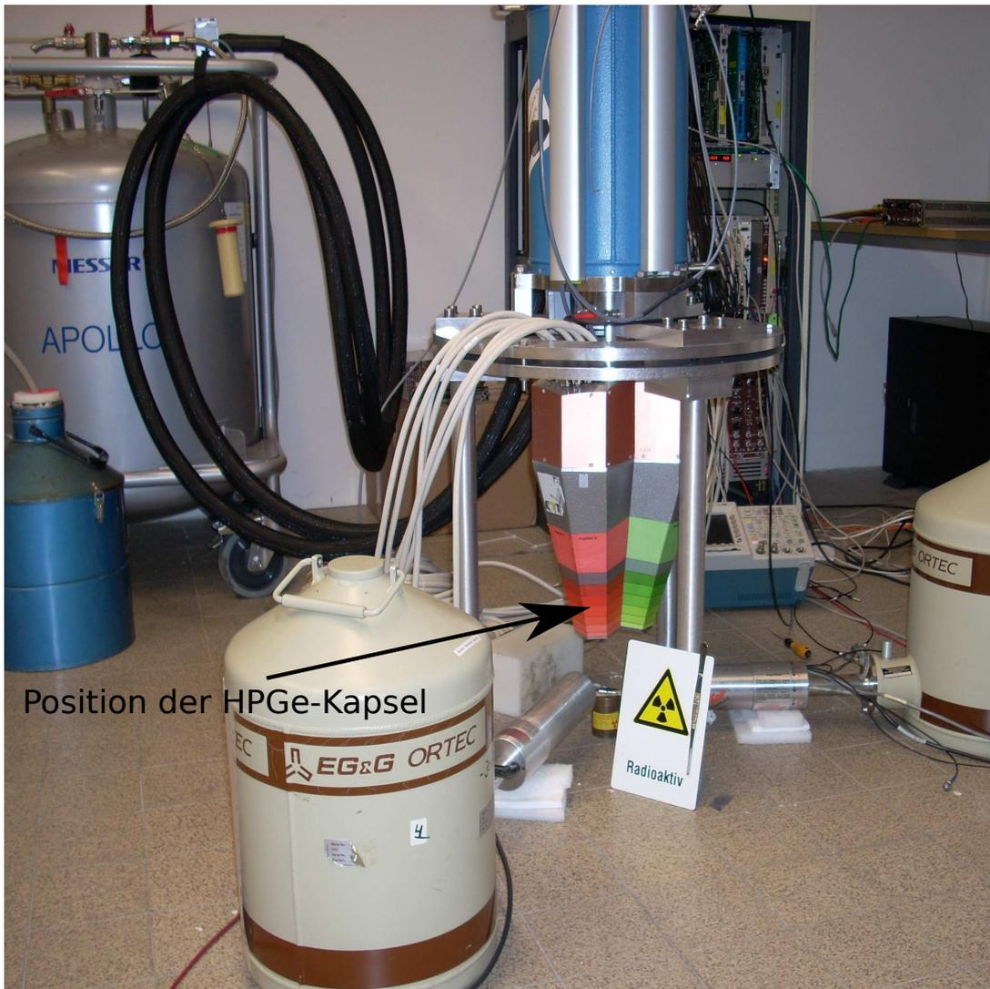
**Abbildung 6.1.:** Experimenteller Aufbau. Die zwei zum DAGATA-Polarimeter senkrecht stehenden Detektoren wurden zu einer Koinzidenzmessung benutzt und als externe Detektoren bezeichnet. Eine  $^{60}\text{Co}$ -Quelle hinter dem Radioaktiv-Schild dient als eine Quelle von Photonen, die bezüglich einer Quantisierungsachse mit einem Polarisationsgrad von  $1/6$  polarisiert sind. Der Pfeil zeigt die in den Tripel-Kryostaten montierte HPGe-Kapsel.
