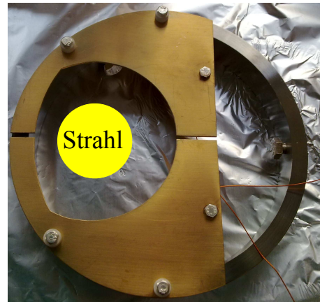
Abbildung 8.11: Foto der vor dem CWT montierten, elektrisch isolierten Bleche.
