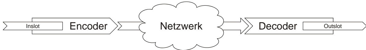
Abbildung 33: Serialisierung und Deserialisierung von Datenwerten über Encoder und Decoder
