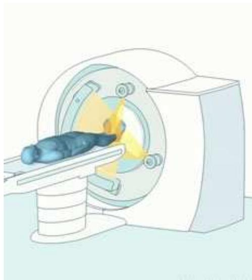
**Abbildung 3.12:** Prinzip des Dual-Source-CT-Scanners: Zwei um  $90^\circ$  gegeneinander verdrehte Quellen-Detektor-Paare rotieren simultan um den Patienten. Damit wird eine effektive Verdopplung der zeitlichen Auflösung erreicht (Quelle: <http://www.siemens.com/dualsource>).
