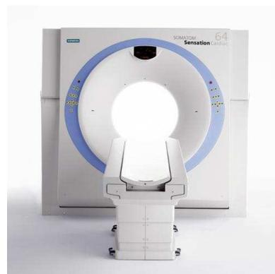
**Abbildung 3.3:** CT-Scanner der aktuellen Generation mit 64 Detektorzeilen. Damit werden jeweils 64 Absorptionsprofile simultan aufgenommen, aus denen aufgrund des Umlaufens von Röntgenquelle und Detektorarray um den Patienten und dem Tischvorschub das 3D-Volumen rekonstruiert werden kann (*links*: Aquilion 64, Toshiba; *rechts*: Somatom Sensation Cardiac 64, Siemens).
