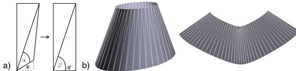
Abbildung 3.8: (a) Abwickeln von Dreiecken: Die Kante  $e$  wird nach  $\mathbb{R}^2$  abgebildet, indem der Winkel zwischen ihr und der diagonalen Kante und auch ihre Länge erhalten bleiben ( $\alpha = \beta$  und  $|e| = |e'|$ ). — (b) Ein elliptischer Kegel und die Abwicklung in die Ebene.
