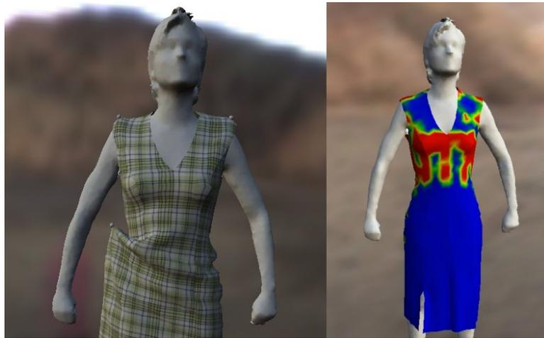
Abbildung 7.2: Links: Interaktives drapieren mit Stecknadeln. — Rechts: Visualisierung von Spannungen im Material
