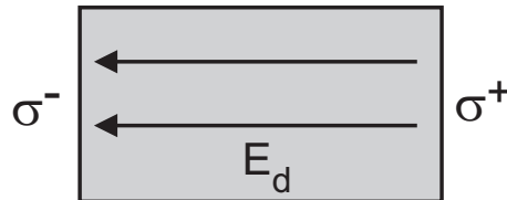
Abbildung 5.2: Grauer Bereich aus Abbildung 5.1 als Kondensator betrachtet.
