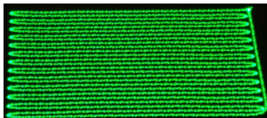
Abb. 5.4: Scan über das gesamte Substrat mit kleineren Pixel- und Linienabständen. Der Scan beginnt in der rechten unteren Ecke und überstreicht das Substrat mäanderförmig.
