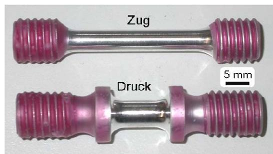
Abbildung 3.3: Proben zur Parameterseparation aus AZ80; oben: Proben zur elektrochemischen Messung unter Zugbelastung; unten: Proben zur elektrochemischen Messung unter Druckbelastung
