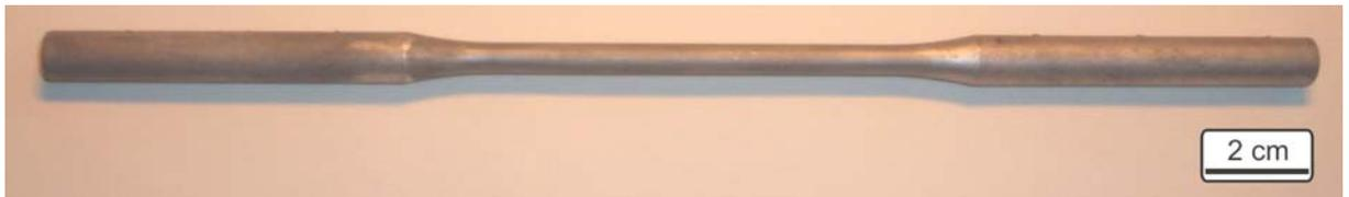
Abbildung 3.1: Direkt gegossene Probenform aus AZ91 hp
