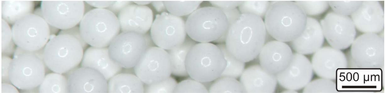
Abbildung 3.7: Keramisches Strahlmittel der Güteklasse B30 auf  $ZrO_2$ -Basis
