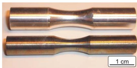
Abbildung 3.2: Probengeometrien der gekehlten Rundproben; oben: EN AW-7050; unten: Ti-Grad 2
