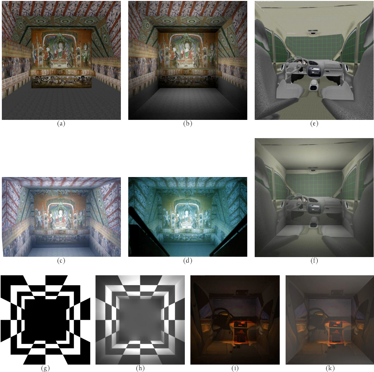
Abb. 18 : Radiositysimulationen für unterschiedliche Testszenen. Dunhuang-Szenario: (a) Optimaler Fall: Uniforme Leuchtdichteverteilung, keine Interreflexion. (b) Die tatsächliche Leuchtdichteverteilung, unter Beachtung von Abb. 14, jedoch noch ohne Interreflexionseffekte. (c) Der Reflexionskoeffizient wird auf 0.5 festgelegt, wodurch Interreflexion erzeugt wird. (d) Fotografie der realen Situation. VW Sharan Testszene: (e) Optimaler Fall. (f) Tatsächliches Erscheinungsbild. Schachbrett Testszene: (g) Optimaler Fall. (h) Tatsächliches Erscheinungsbild. BMW Testszene: (i) Tatsächliches Erscheinungsbild. (k) Streulicht durch einen in 3m Abstand vom Eingang platzierten, simulierten Monitor mit 100 \text{ cd/m}^2 .
