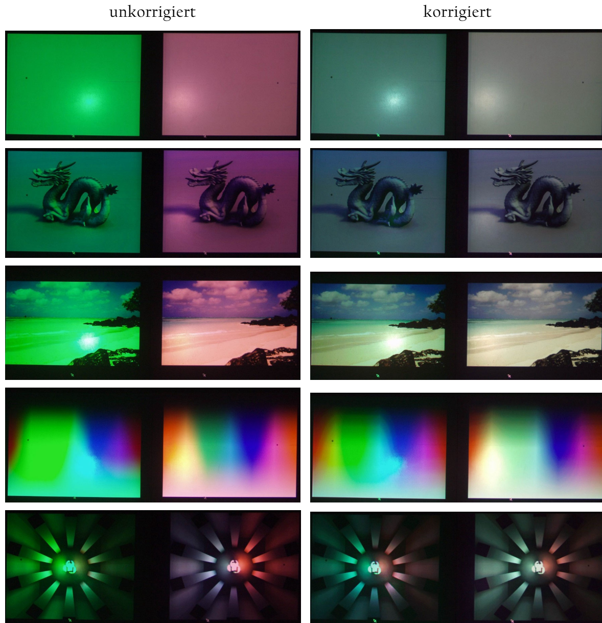
Abb. 26 : Vergleich zwischen unkorrigierten (links) und korrigierten (rechts) Bildpaaren. Deutliche Unterschiede in der rechten Spalte werden verursacht durch Abweichungen in der Spektralantwort der Kamera, sowie insbesondere durch Ausdrucken auf einem nicht kalibrierten Drucker.
