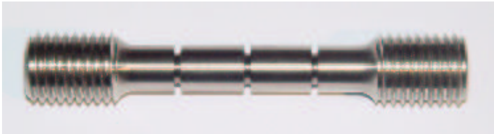
Abbildung 7.14: Gekerbte Rundprobe aus \text{Ni}_3\text{Al} , die Orientierung des Einkristalls in der Probe ist durch \varphi_1 = 5,6^\circ und \varphi_2 = 14,9^\circ gegeben.
