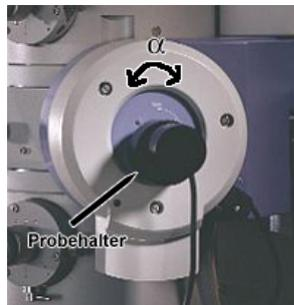
Abbildung 4.6: Im Goniometer eingebauter Probenhalter
