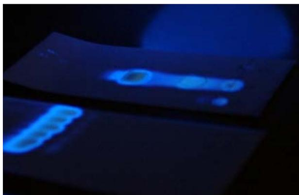
Abbildung 9: DC-Detektion von Acridon bei einer Wellenlänge von 366 nm
