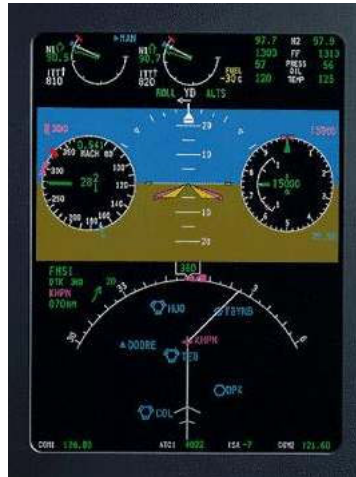
Abb. 3.2: Multi Function Display
