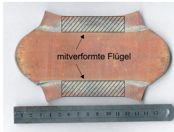
Abbildung 5.28: Geometrie der Walzprobe nach dem Walzen
