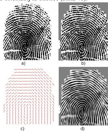
Slika 4 – 1D glajenje: a) originalna slika; b) segmentirana slika; c) orientacijsko polje; d) izboljšana slika.
