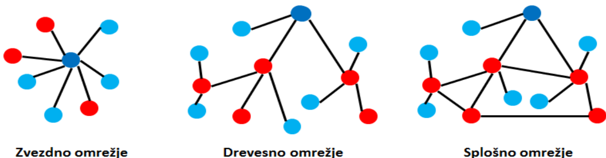
Slika 2: Tipi omrežij in naprav. S svetlo modro so označene končne naprave, z rdečo usmerjevalniki in s temno modro koordinatorji.
