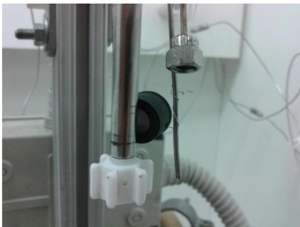
**Figura 4.4:** Rappresentazione del corretto posizionamento del disco di palladio policristallino.
