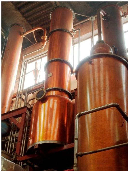
Figura 11 - Colonna di distillazione discontinua installata presso la distilleria Bonollo.
