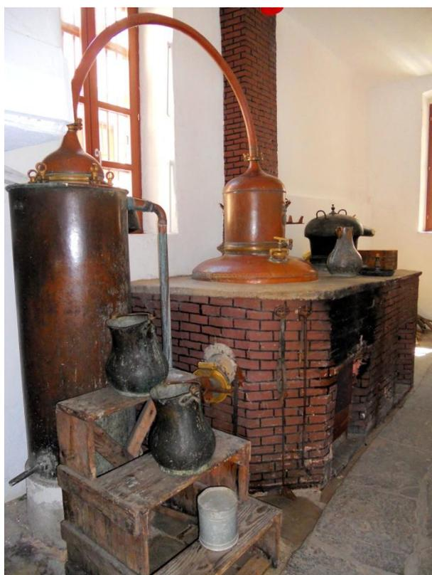
Figura 3 - Sistema per la distillazione da bucce di cedro di inizio secolo scorso tipico delle isole greche. Si distinguono la caldaia, il collo di cigno e il condensatore.
