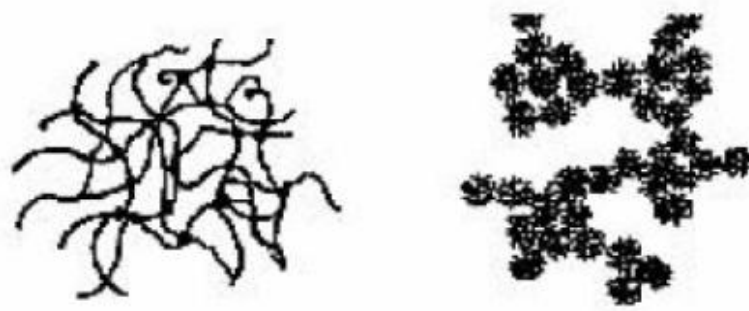
Figura 1- Differente sviluppo di son-gel con catalisi acida, a sinistra, e basica, a destra.
