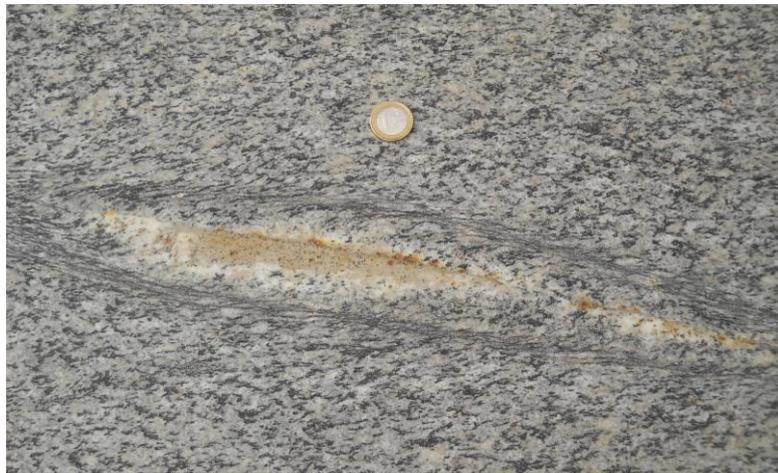
*Fig. 7: Vena di epidoto circondata da alone di alterazione, e successivamente deformata formando una paired shear zone.*
