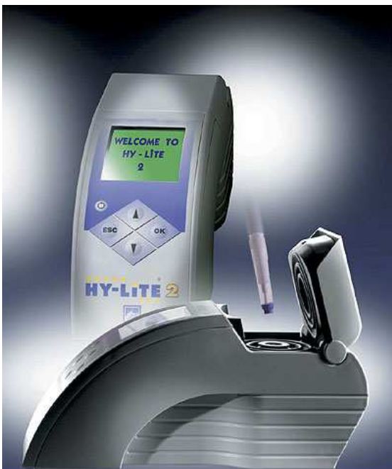
Figura 2.11: L'Hy-Lite 2, strumento che utilizza il principio della bioluminescenza dell'ATP.
