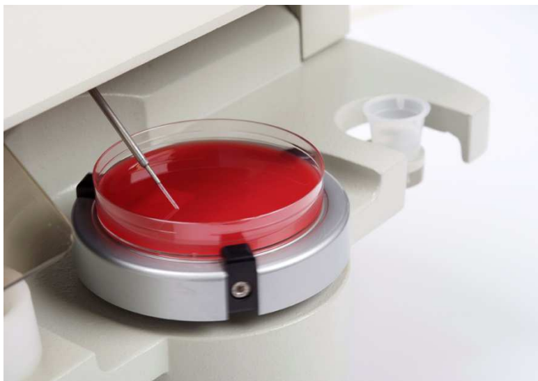
Figura 2.10: dettaglio del System: la base rotante su cui è inserita la piastra Petri e l'ago.
