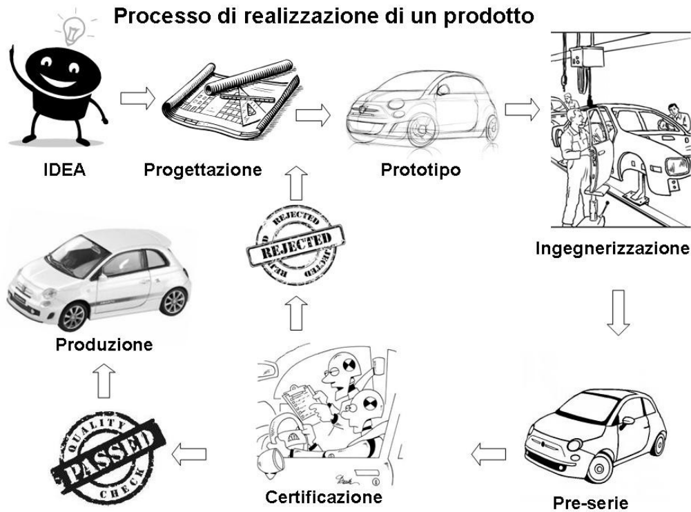
Fig. 2 - Processo di realizzazione classico.
