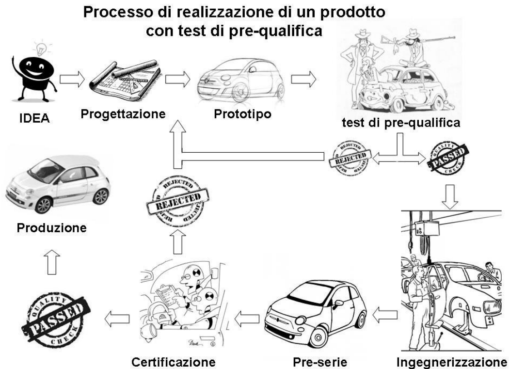
Fig. 3 - Processo di realizzazione ottimizzato.
