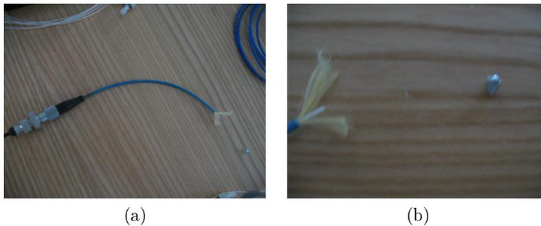
Figura 2.17: Metallizzazione di una semi-bretella in fibra ottica con lo stagno.
