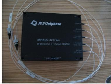
Figura 2.2: Un esempio di WDM utilizzato (JDSU).
