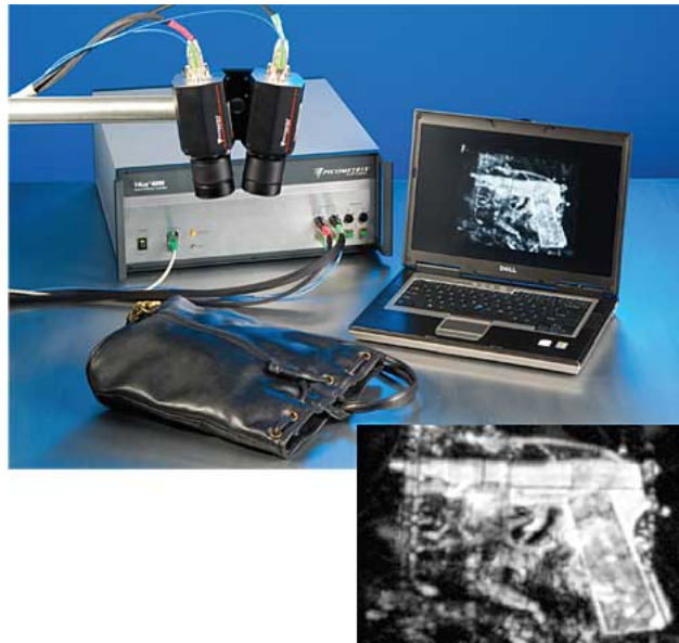
Figura 1.1.7: Borsetta contenente un'arma vista tramite raggi Terahertz [18]
