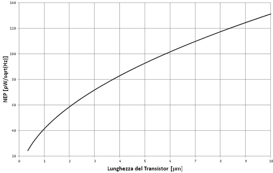
Figura 3.1.4: NEP in funzione della lunghezza del transistor utilizzato come rivelatore
