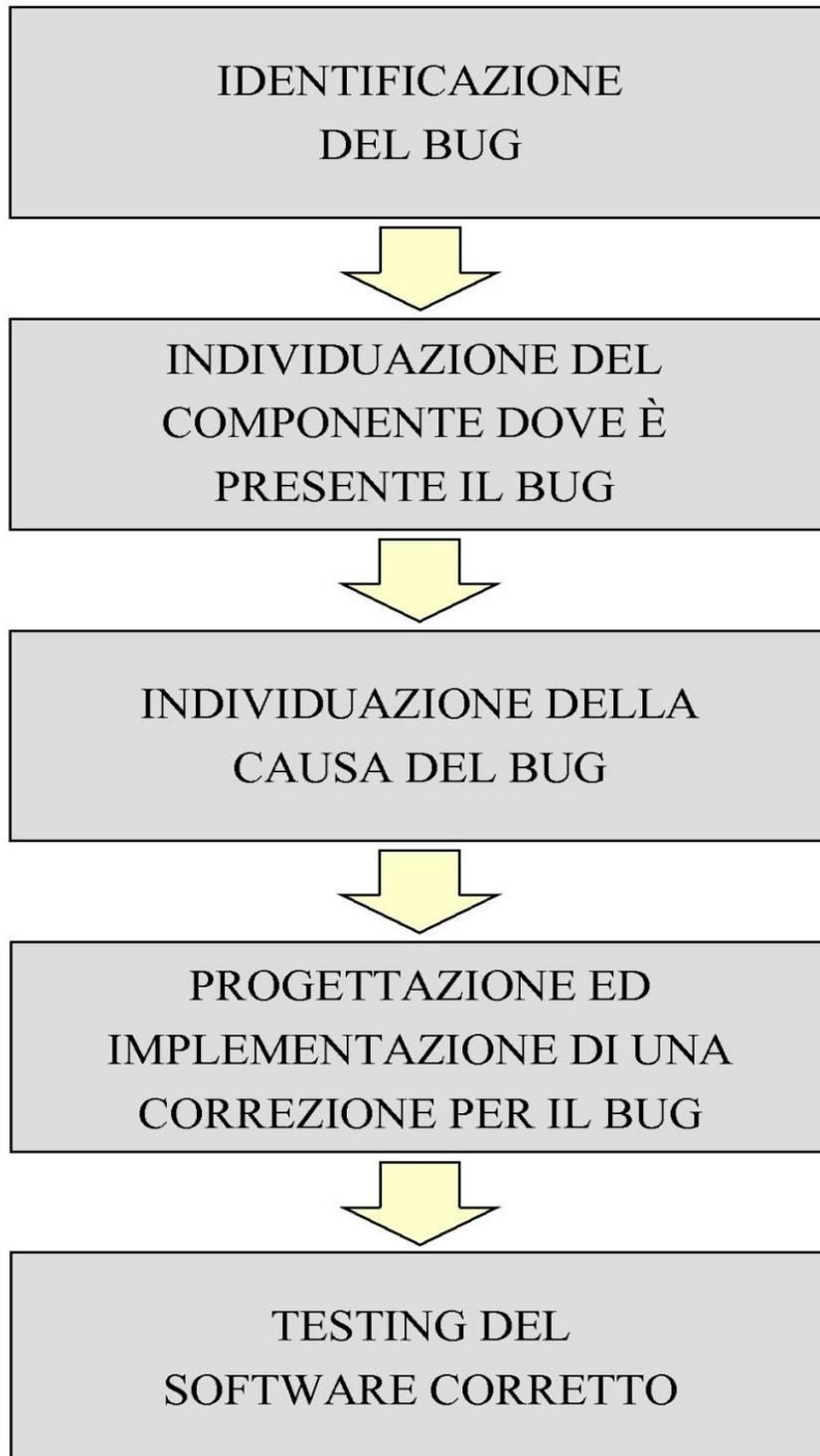
Figura 5: Schema evolutivo del processo di debug
