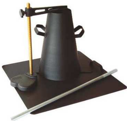
Fig. 2.3: cono di Abrams a sinistra; a destra una misura di slump
