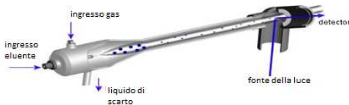
Fig. 3.5: principio di funzionamento ELSD
