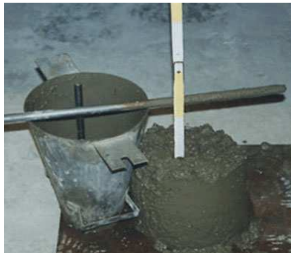
Fig. 2.3: cono di Abrams a sinistra; a destra una misura di slump
