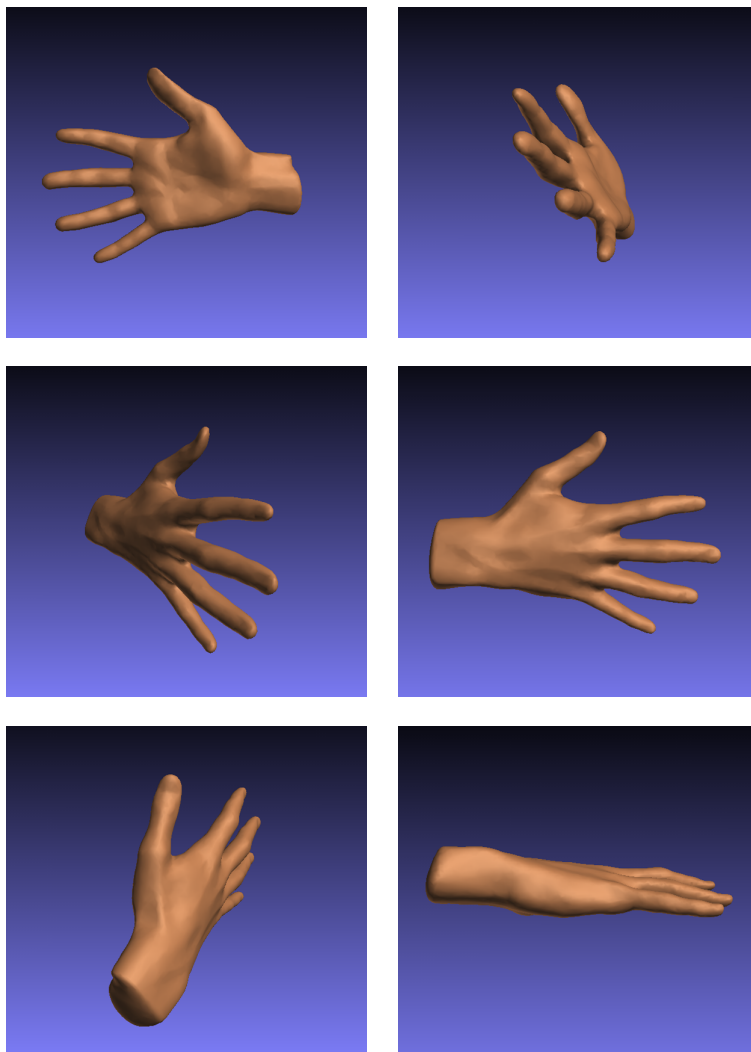
Figura 3.14: Esempio di decimazione della mesh in Figura 3.13 tramite l'algoritmo[13].
