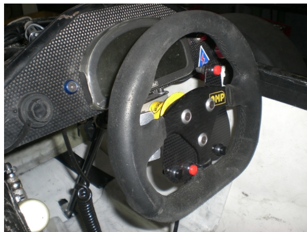
Figura 1.4: Il Motec ADL2 montato in vettura
