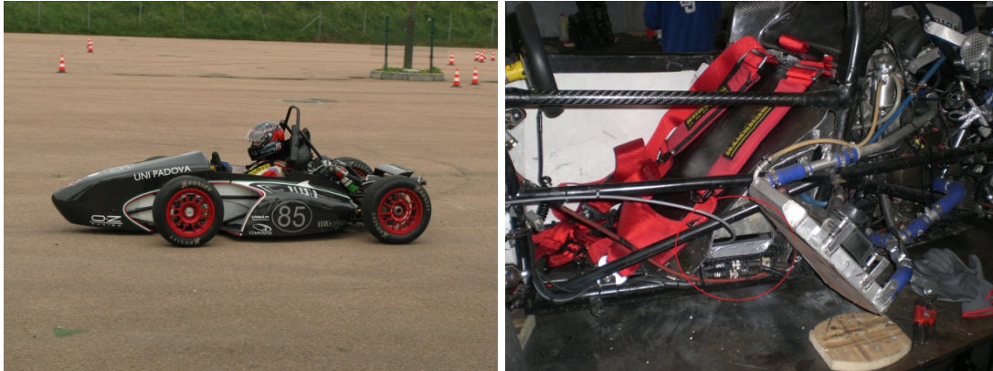
Figura 5.2: Posizione della scheda in vettura con e senza carrozzeria
