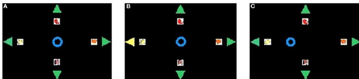
Figura 2.1.1: *Interfaccia utilizzata nel sistema BCI del San Camillo [39]. (A) Se il target è indicato dalla freccia LEFT, in corrispondenza dello stimolo visivo (B) il soggetto riconosce l'evento target, si elicitava la componente P300, la quale viene rilevata dal classificatore, generando in output lo spostamento del cursore verso lo stimolo (C).*
