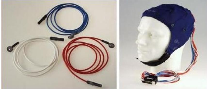
Figura 1.3.4: *Esempio di elettrodi a coppetta (sinistra) e di una cuffia per acquisizione EEG (destra) [s14].*
