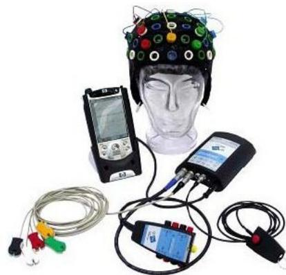
Figura 1.3.7: *Esempio di un sistema portatile per acquisizione EEG [s10].*
