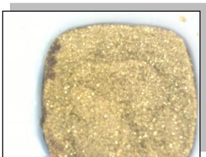
La resina anionica utilizzata è la MTO-Dowex M43 Anion Exchange Resin (SUPELCO Analytical) .
