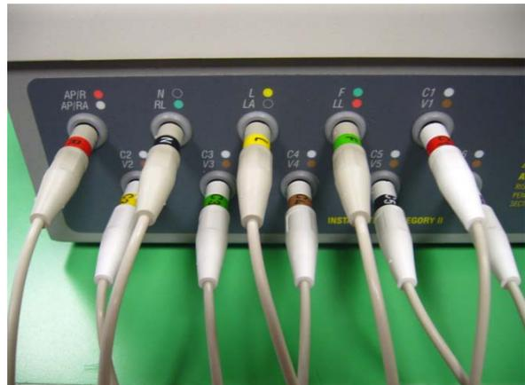
Figura 4.1 Connessione cavi elettrocardiografo con analizzatore 601 PRO SERIES XL (foto).
