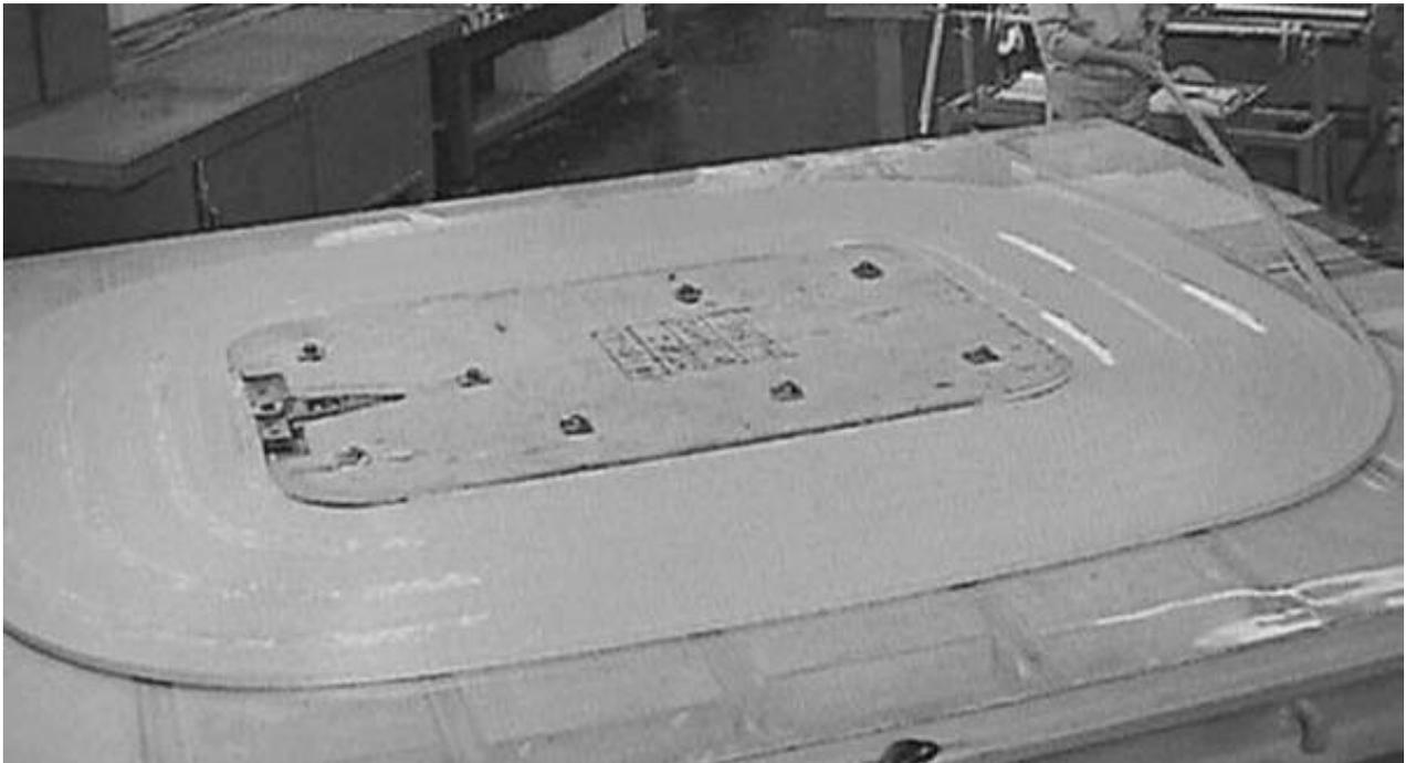
Figura:3.1.5 durante il processo di avvolgimento
