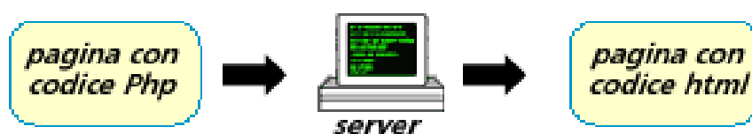
Figura 10: elaborazione dei file php da parte del server
