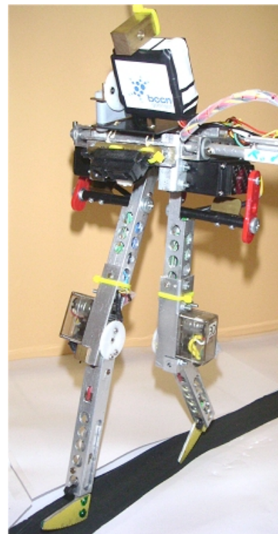
Abb. 46: Selbst-lernender, dynamischer Roboter, der auf Basis der Theorien N. A. Bernsteins am Bernstein Center for Computational Neuroscience Göttingen 2006 entwickelt wurde. Der »Runbot« gilt im Verhältnis zu seiner Körpergröße von 23 cm als schnellster zweibeiniger Roboter der Welt.(3,5 Beinlängen pro Sekunde, was mehr als doppelt so schnell wie ein durchschnittlicher Spaziergänger ist).
