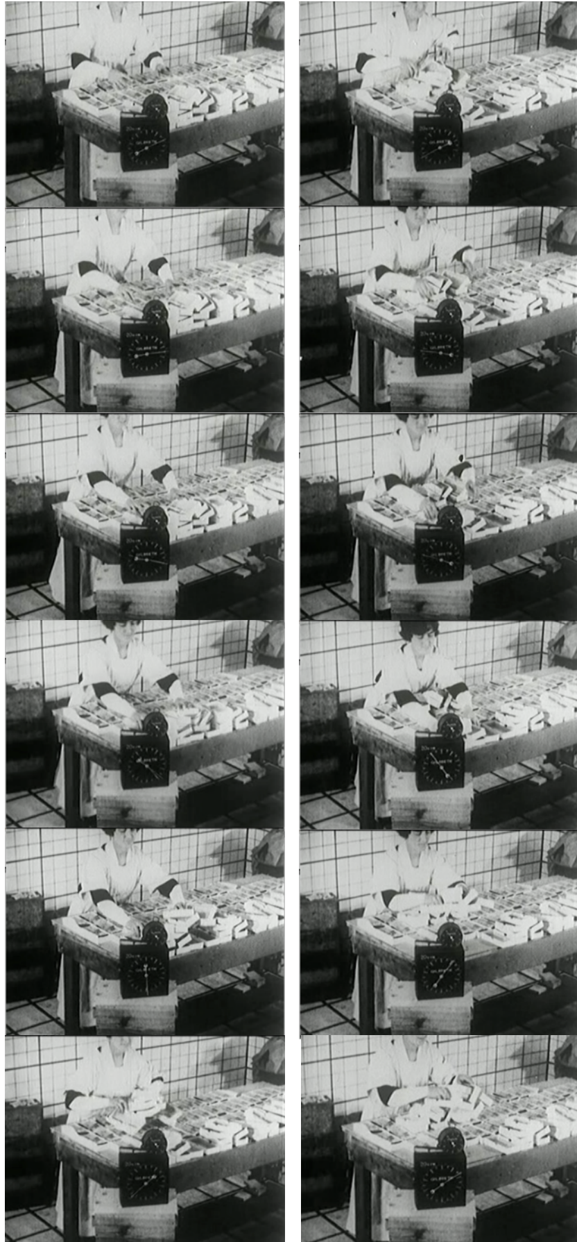
Abb. 22: Typisches Beispiel eines Micro-Motion-Films. Gilbreth filmt die Bewegungen einer Arbeiterin beim Einpacken von Seife. Die Gilbreth-Uhr und der gerasterte Hintergrund sind in den Aufnahmen deutlich erkennbar. (Leserichtung: von oben nach unten, von links nach rechts)
