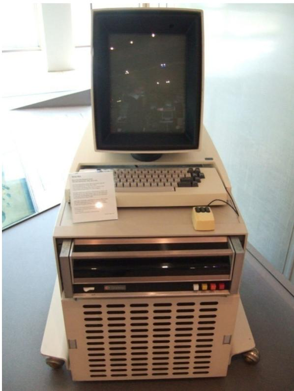
Wie in Abbildung 8 zu erkennen, verfügte dieser Vorreiter des PCs über Grafikbildschirm, Tastatur und Maus, sowie über einen Prozessor in Verbindung mit bis zu zwei Plattenlaufwerken. Diese hatten eine Speicherkapazität von jeweils 2,5 Megabyte, während der Prozessor mit einer Taktrate von 5,88 Mhz aufwarten konnte.
