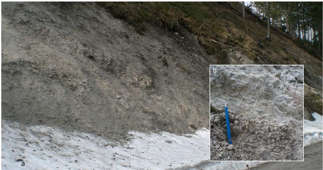
Abb. 11 a: Aufschluss Steinalpl Blick Richtung SW; b: Detailansicht aus Aufschluss F15: Übergang eines geklüfteten Dolomits der Fracture Fazies 4 (unten) zu einer Dilation Breccie (oberer Bildbereich); c: Strukturdaten F15
