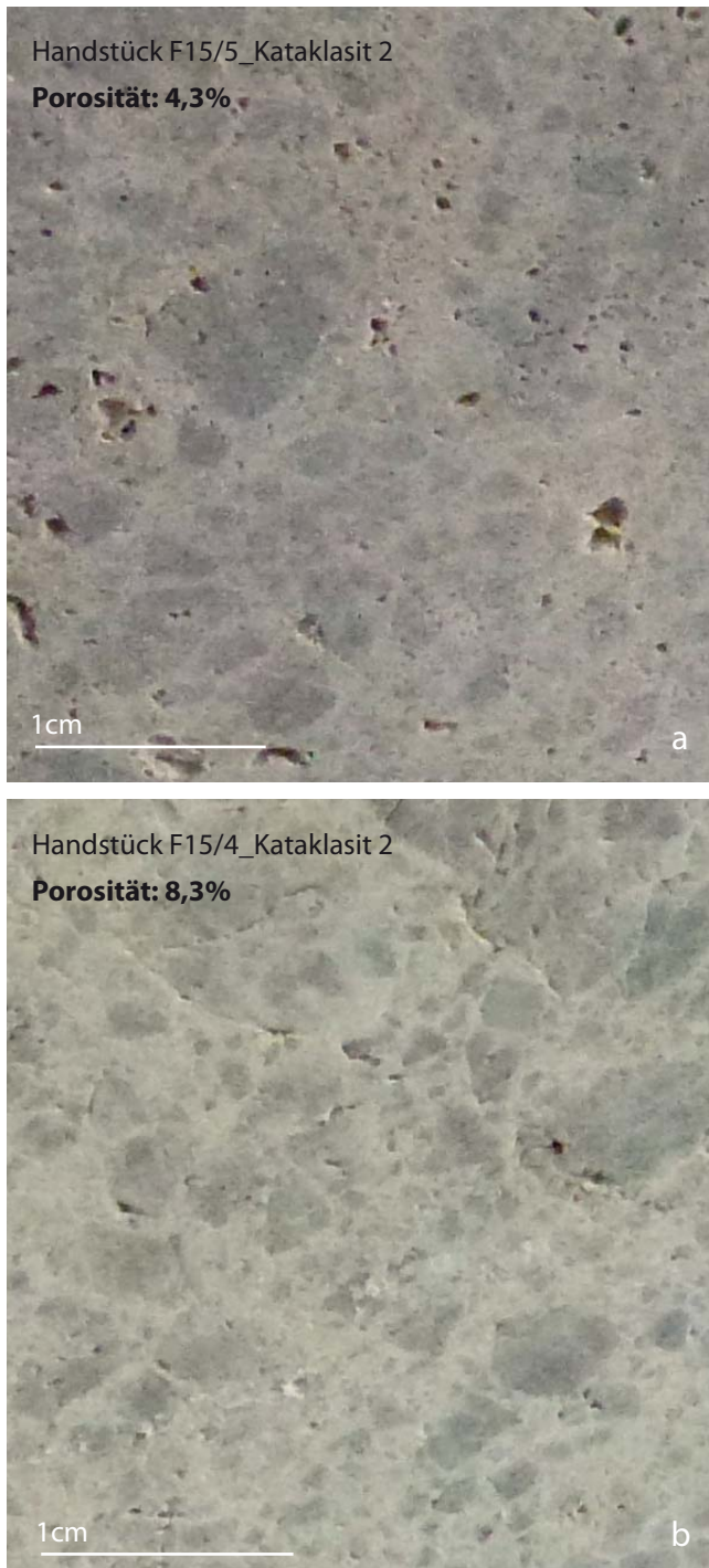
Abb.69 Die Bilder a und b geben einen makroskopischen Vergleich der beiden Handstücke F15/4 und F15/5, die beide als Kataklasit 2 klassifiziert wurden und die- vermutlich rein aufgrund ihres unterschiedlichen Matrixaufbaues - eine deutliche Divergenz im Porositätswert aufweisen
