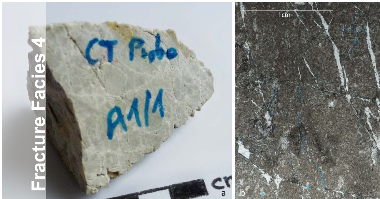
Abb. 41 a: Handstück A1/1; b: Ausschnitt aus dem Panoramafoto des Dünnschliffes von Handstück A1/1. Deutlich zu sehen sind subparallele kalzitisch gefüllte Klüfte, sowie ein feineres offenes Kluftsystem, das mit blauem Epoxidharz gefüllt ist. Bereiche, die dunkler erscheinen sind stets durch Kornzerkleinerung gekennzeichnet.
