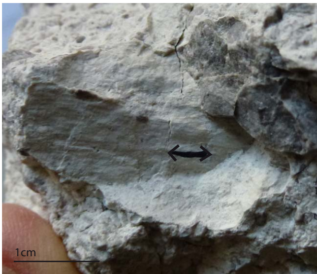
Abb. 74 Eine ausgebrochene dolomitische Protolithkomponente gibt den Blick auf eine eindeutige Lineation in der Matrix frei. Diese Beobachtung unterstützt die Annahme der Bewegungsmöglichkeit einzelner Protolithkomponenten durch die unzementierten Feinstkornsäume, die im Elektronenmikroskop entdeckt wurden.
