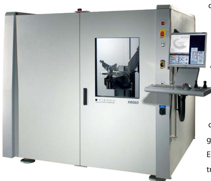
Abb. 43 Das Viscom X8060 NDT -Röntgeninspektionsgerät; am selben Gerätetyp wurden die Messungen am Departement für Anthropologie der Universität Wien durchgeführt.
